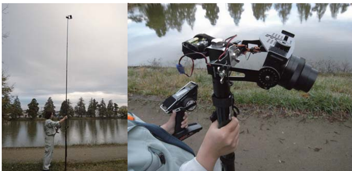
図2 低空空撮システム（7m ポールと先端の遠隔操作機器）
