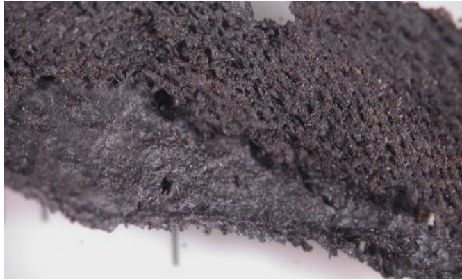
Fig.10 試料5。試料の下半分には黒くて粘度のある物質が塗布され、固められているように見える。
